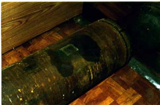
Prüfmuster mit großem Durchmesser. Defekt „Riefen-Risse“ vor und nach der Reparatur. Specimen with large diameter. Defect "score-cracks" before and after repair.
