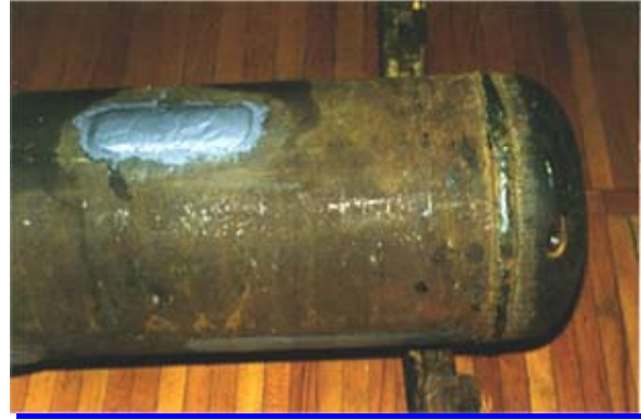
Fig. 2.20. Rohrmuster mit großem Durchmesser (Typ B) (alle Defekte auf dem Muster dargestellt) Fig. 2.20. pipe specimen with large diameter (Type B) (all defects marked on specimen)
