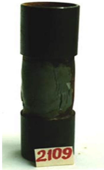
Fig. 2.13. Typisches Muster mit Defekt „rundes Loch“. Lebensdauerprobe 7 Jahre 315 atm. „Erschöpfungsdruck“.
