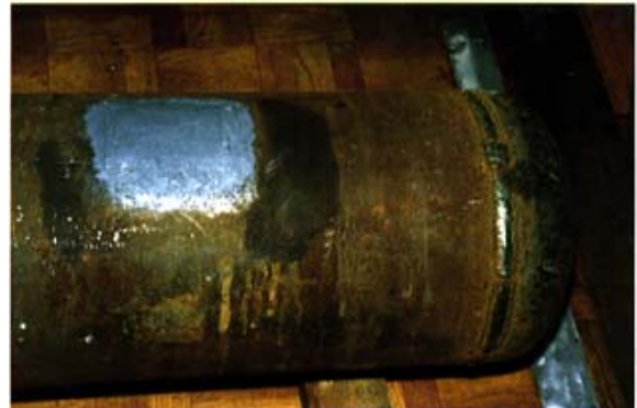
Prüfmuster mit großem Durchmesser. Defekt „Riefen-Risse“ vor und nach der Reparatur. Specimen with large diameter. Defect "score-cracks" before and after repair.
