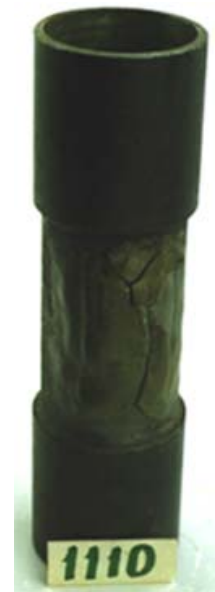
Fig. 2.16. Typisches Muster mit Defekt „länglicher Riß“ Lebensdauerprobe 3,5 Jahre 175 atm. „Erschöpfungsdruck“.
