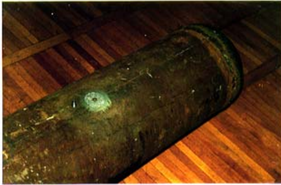
Prüfmuster mit großem Durchmesser. Defekt „rundes Loch“ vor und nach der Reparatur. Specimen with large diameter. Defect "round hole" before and after repair.
