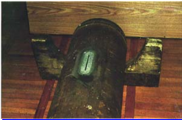
Fig. 2.20. Rohrmuster mit großem Durchmesser (Typ B) (alle Defekte auf dem Muster dargestellt) Fig. 2.20. pipe specimen with large diameter (Type B) (all defects marked on specimen)
