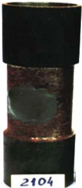
Fig. 2.3. Typisches Muster mit Defekt „rundes Loch“. Lebensdauerprobe 3,5 Jahre 330 atm. „Erschöpfungsdruck“
