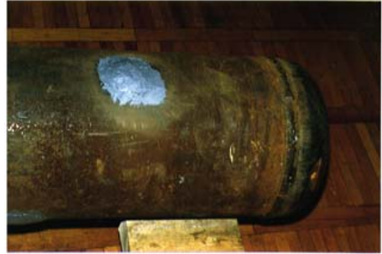
Prüfmuster mit großem Durchmesser. Defekt „rundes Loch“ vor und nach der Reparatur. Specimen with large diameter. Defect "round hole" before and after repair.
