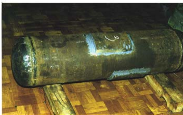
Prüfmuster mit großem Durchmesser. Defekt „länglicher Riss“ nach der Reparatur. Specimen with large diameter defect "long crack" after repair
