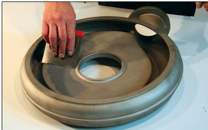
Bild 2: Nach der Aushärtung kann der hochwertige, lösemittelfreie Polymerwerkstoff wie Metall bearbeitet und überlackiert werden. Ob Eisen oder Edelstahl, Aluminium oder Kupfer: DIAMANT ultrametal Smart verleiht den ausgebesserten Stellen des Gussteils einen perfekten Metallcharakter.
