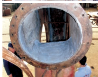
Beschichtung eines Pumpengehäuses
