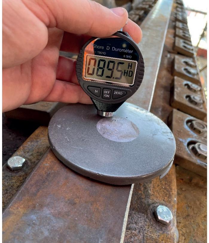
Der nach dem Absetzen der Kranschiene austretende Überschuss an MM1018 P wurde vom DIAMANT Montageteam sorgfältig entfernt. Vor der Freigabe der sanierten Kranbahn für den Betrieb wurde die Shore-D-Härte gemessen. Bild: DIAMANT®.
