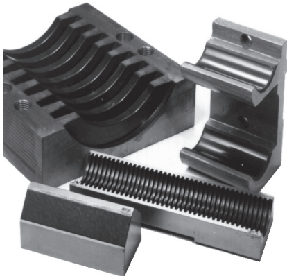
Bild 3: Schnecken Zahnstange, Stützlager, Mutter, Keil - abgeformt mit SKC-Gleitbelägen
