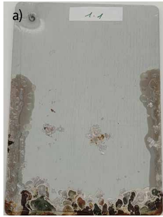
Bild 6: Auslagerungsversuche in 5 %iger NaCl-Lösung bei 25 °C nach 4 Wochen: Stahlblech mit (a) großen und (b) geringen Korrosionsschäden
